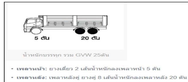
รูปที่ 3 พิกัดน้ำหนักรถกึ่งพ่วงบรรทุกสิบล้อ
